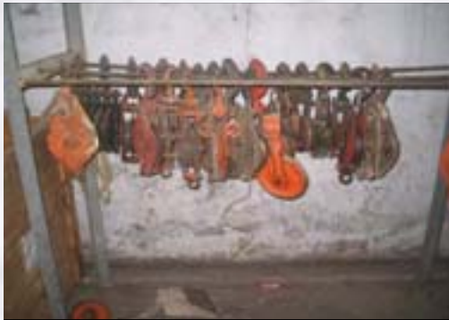
Poleas destinadas al montaje de torres.
