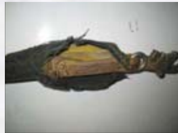
Equipos de protección contra caídas en mal estado, que deben ser rechazados y retirados del servicio.
