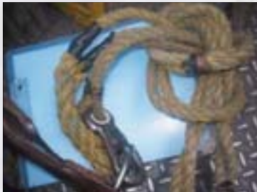
Equipos de protección contra caídas en mal estado, que deben ser rechazados y retirados del servicio.
