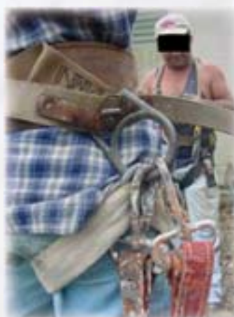
Equipos improvisados y en mal estado, usados para la pintura de torres.
