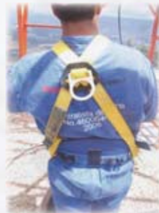
Arneses de cuerpo completo para trabajo en torres, que incluyen argollas para las conexiones respectivas.
