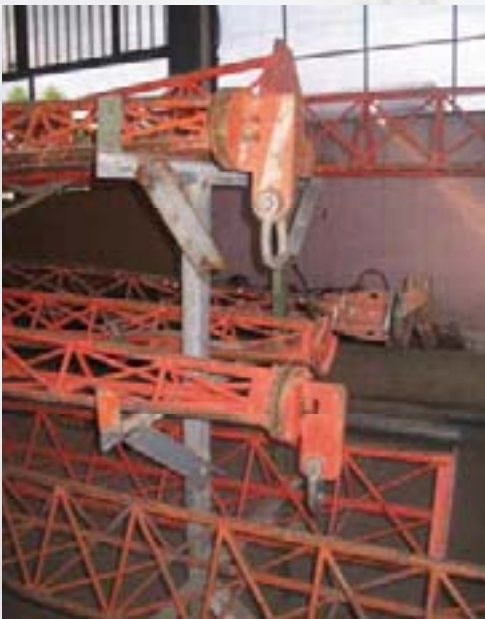
Plumas destinadas al montaje de torres.
